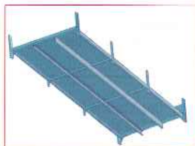
De ontwikkelde vloer, uitgebreid met twee stalen dwarsbalken.
